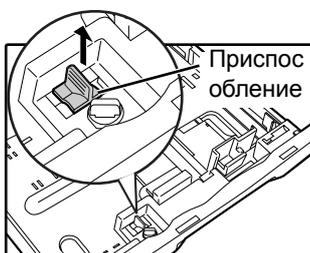
**5** Установите приспособление на коротрон и аккуратно перемещайте вдоль зарядного устройства в направлении, указанном стрелкой. Повторите перемещение два – три раза.
